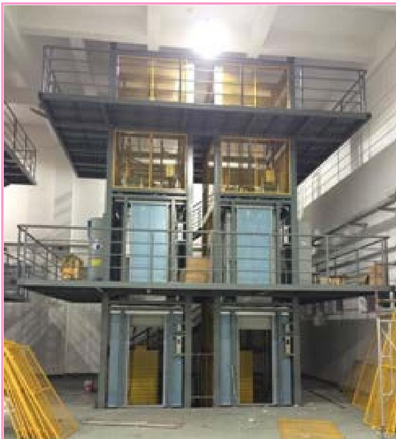
根据电梯安装与维修教程要求进行设计，设备井道外部采用型材或框架制成，能实现满足GB7588要求的乘客电梯的载客和安全保护功能。
