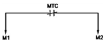
图 20 热敏开关触点接线图
