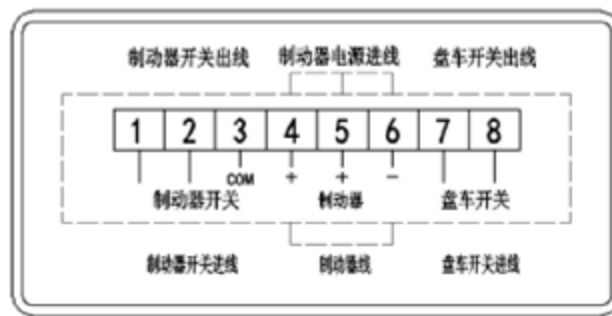
图 17 制动器接线图(DC)
