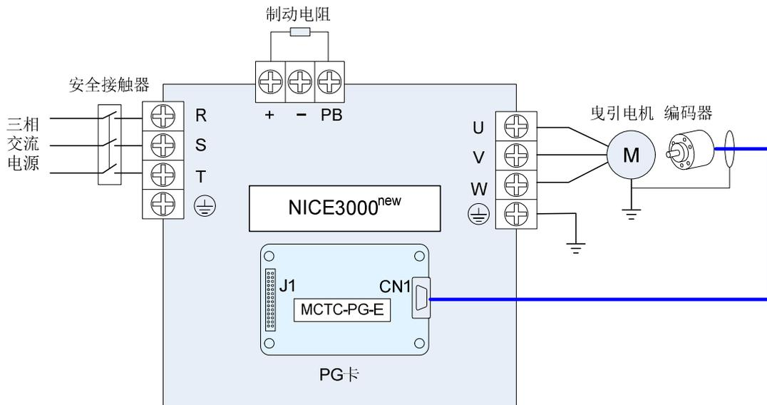
图3-15 MCTC-PG-E与NICE3000<sup>new</sup>的电气接线示意图
