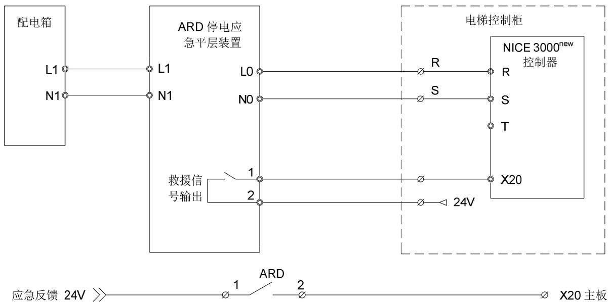
图5-9 单相ARD应急电源方案原理图
