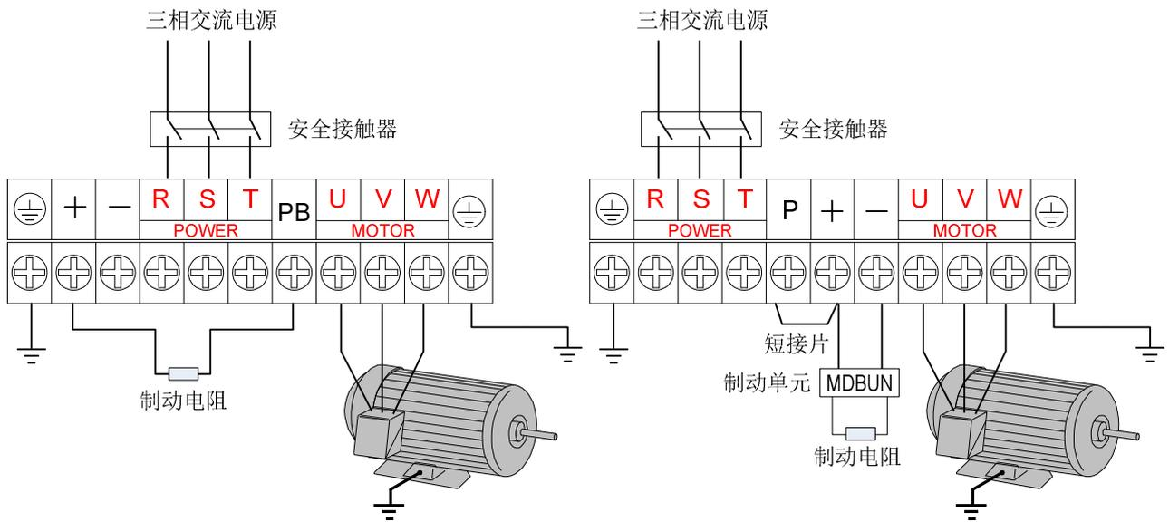
37kW以下机型主回路接线
