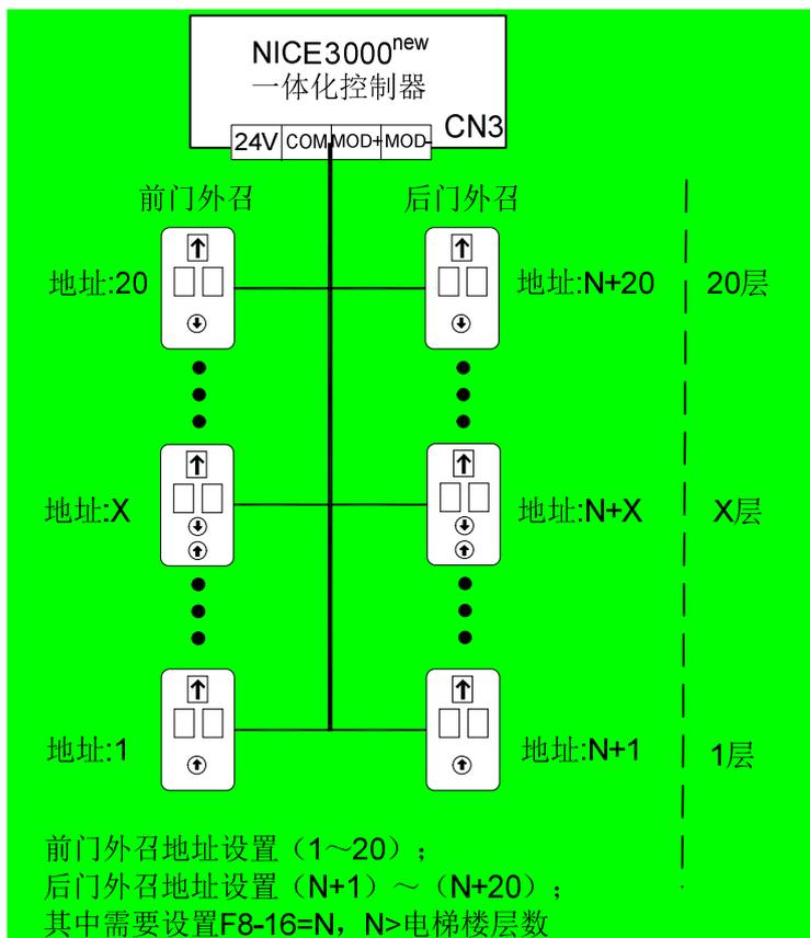
图5-18 实现方法B的显示板接线及地址设置方式
