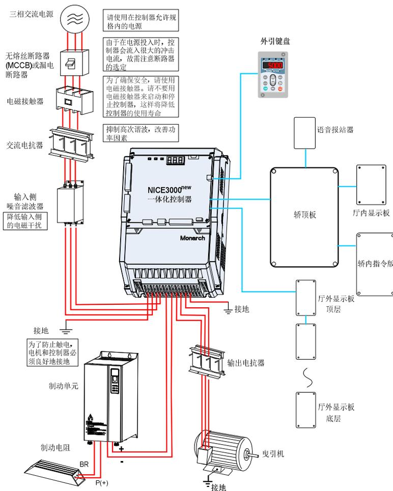
图1 NICE3000<sup>new</sup>一体化控制器与外围设备连接图
