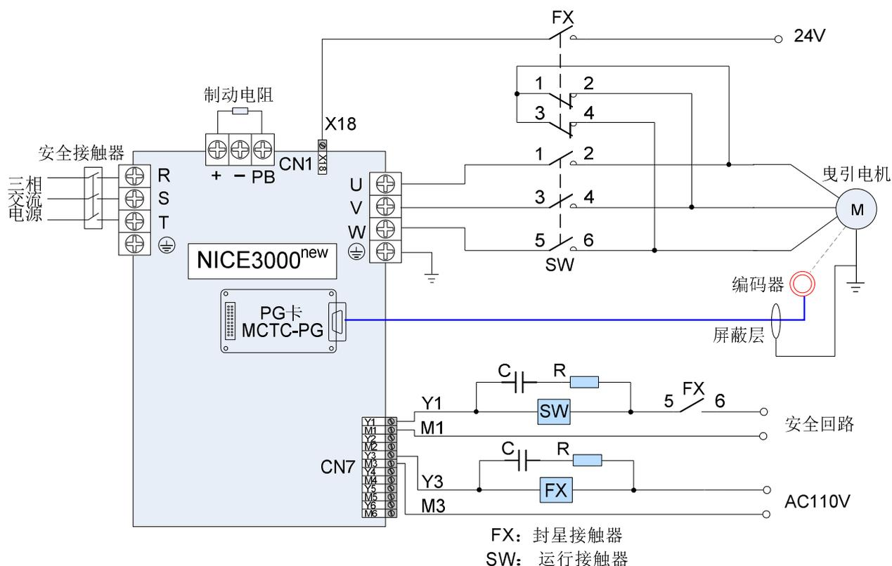
图5-10单独封星接触器接线示意图
