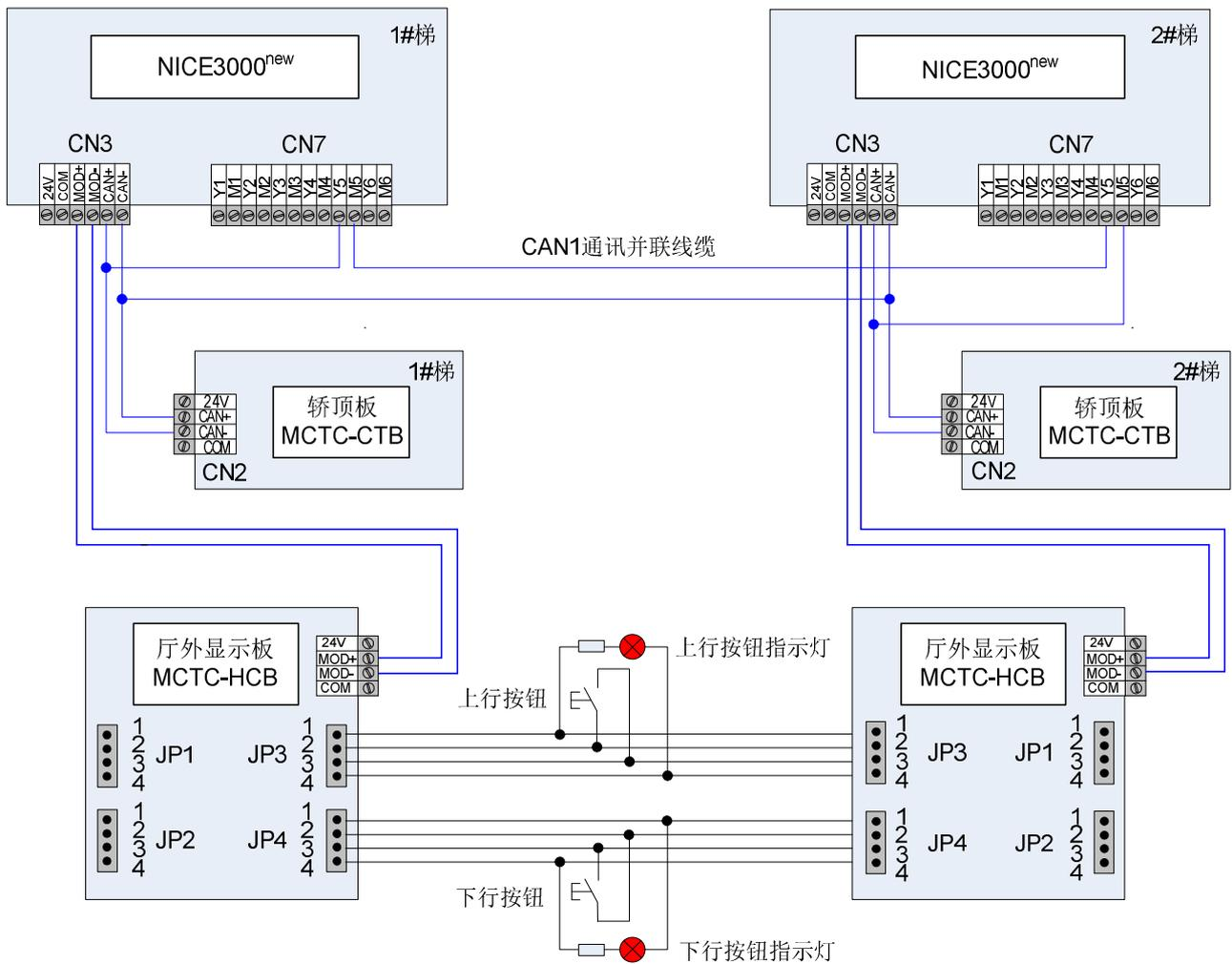
图5-11 使用CAN1通讯并联接线示意图
