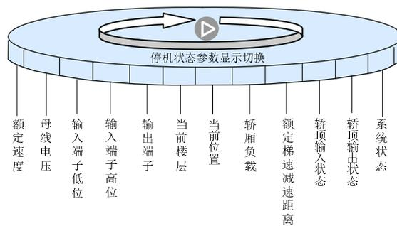
图4-6 停机状态参数的显示切换图
