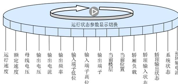
图4-7 运行状态参数的显示切换图
