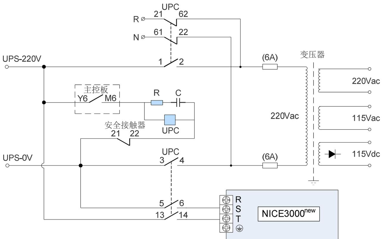
图5-6 220V UPS应急电源回路图
