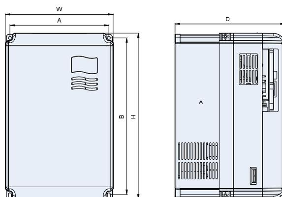
图2-7 L1结构尺寸示意图
