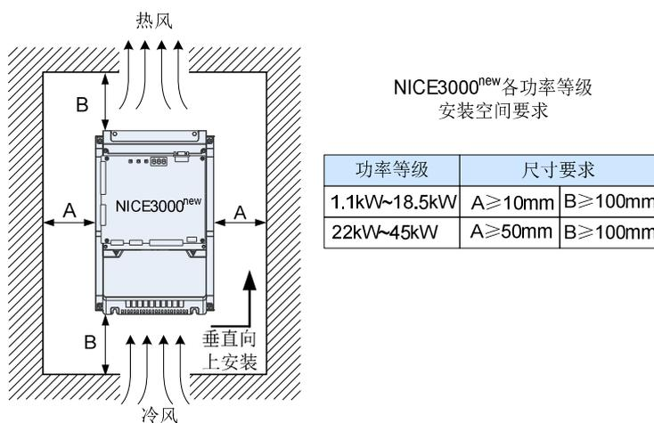
图3-1 安装距离示意图
