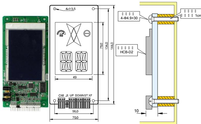
图3-10 HCB-D2外观、尺寸及安装示意图(单位：mm)
