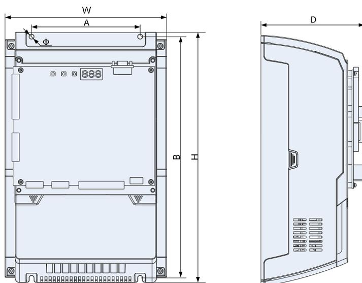
图2-6 NICE3000<sup>new</sup>一体化控制器尺寸示意图
