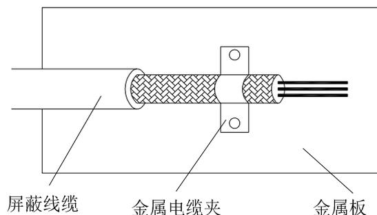
图9-3 使用金属电缆夹固定屏蔽层
