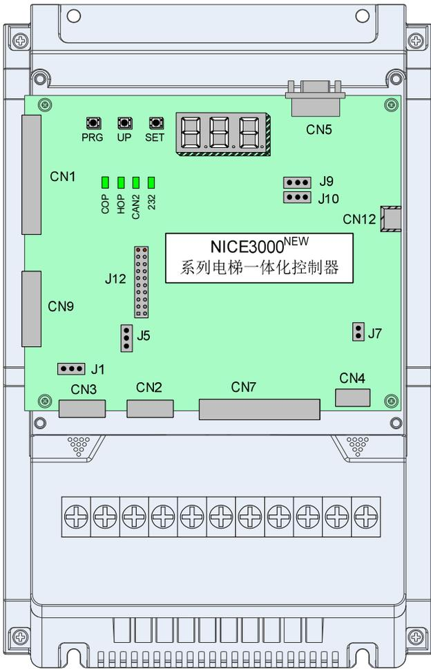
图3-3 NICE3000<sup>new</sup>系列电梯一体化控制器端子分布图
