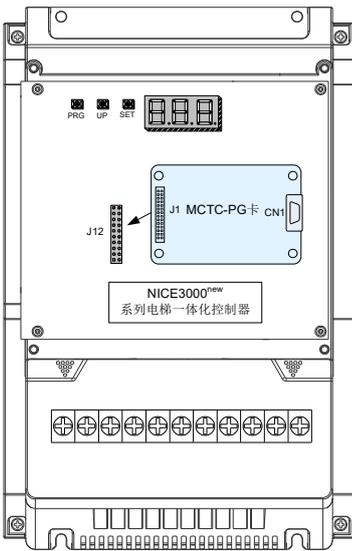
图3-14 MCTC-PG卡实物及安装示意图
