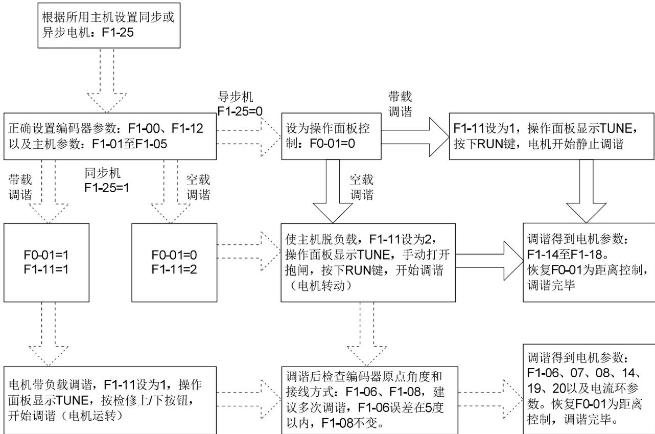
图5-2电机调谐流程图
