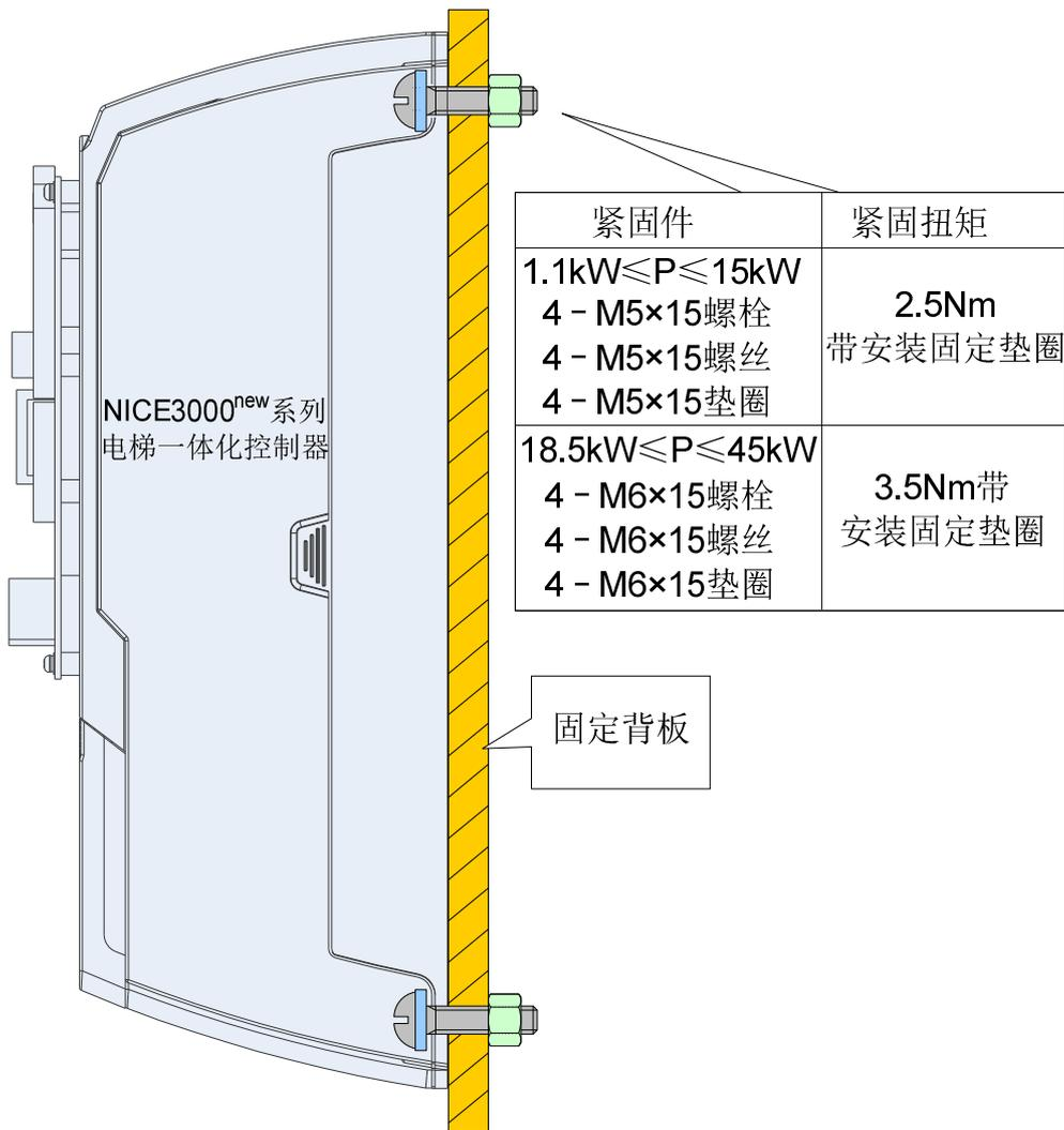
图3-2 安装孔位紧固示意图
