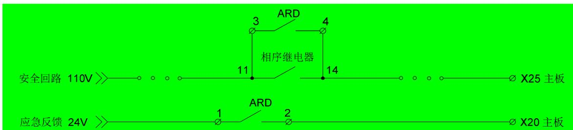
图5-8 三相ARD应急电源方案原理图
