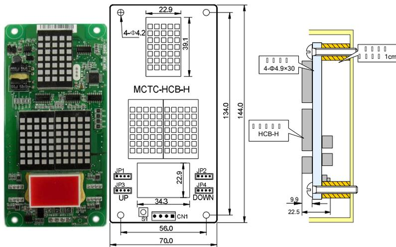
图3-8 HCB-H外观、尺寸及安装示意图(单位: mm)
