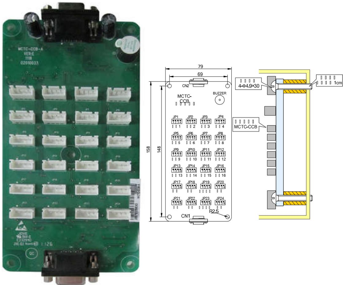
图3-13 内招板外观、尺寸及安装示意图(单位: mm)
