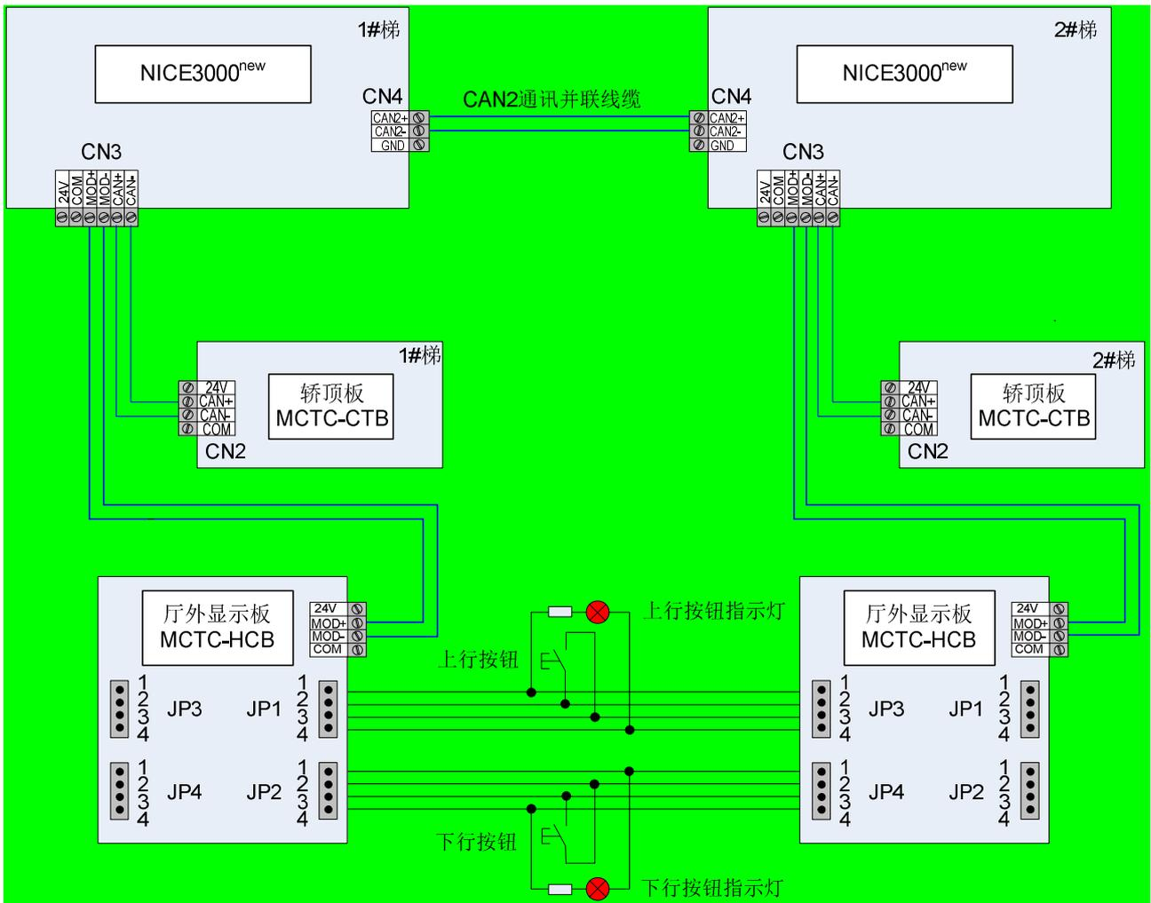
图5-12 使用CAN2通讯并连接线示意图
