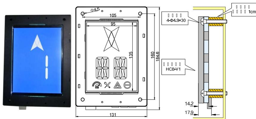
图3-12 HCB-V1外观、尺寸及安装示意图(单位：mm)
