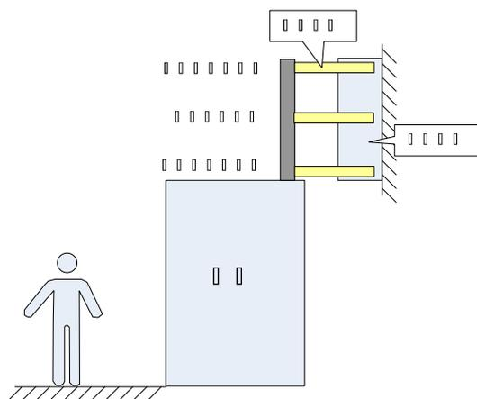
图3-17 平层开关安装位置示意图
