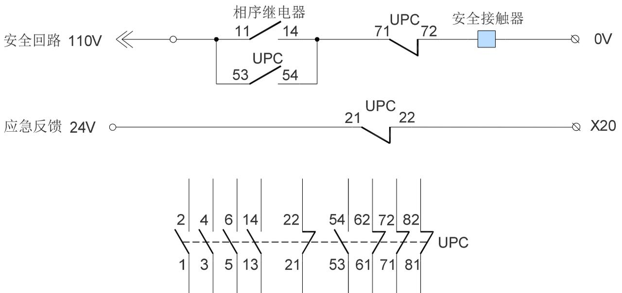
图5-7 接触器各触点示意图
