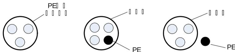
图9-1 屏蔽电缆横截面示意图
