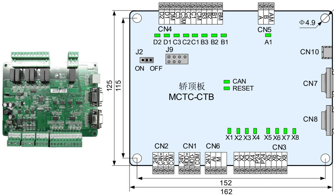
图3-6 轿顶板外观及尺寸(单位: mm)
