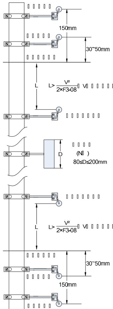
图3-16 井道位置信号安装示意图
