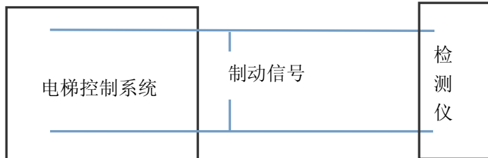
图 2.5 停梯控制连接示意图
