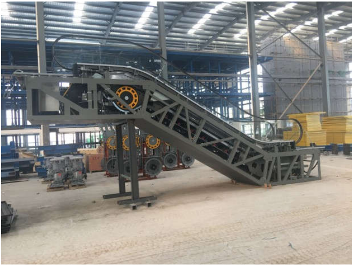
（图 1 扶梯维修用整梯）
